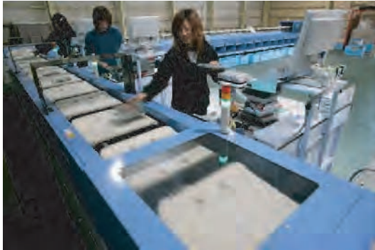
AVソフト(ゲーム・CD・DVD)から科学製品などを扱える自動ソータを導入。1日1万個以上を仕分けできる
