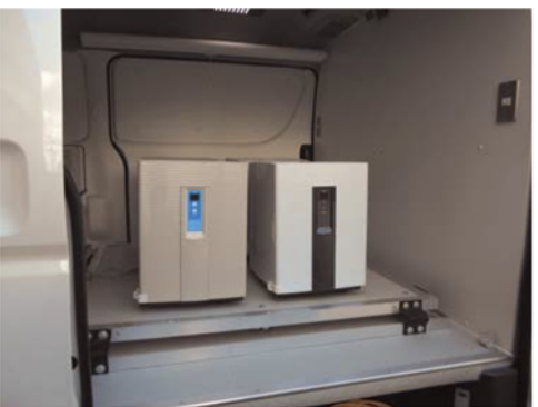
輸送対象はiPS細胞由来の心筋細胞と神経細胞、肝細胞の3種類。横浜市にあるリプロセルの研究所で作製する。柴又運輸は、さいたま市と大阪府東大阪市の拠点に、恒温輸送の専用車を配備する。冷凍や解凍処理などが恒温輸送専用車の車内。細胞を入れる恒温器を防振台の上に置き、振動を抑える
